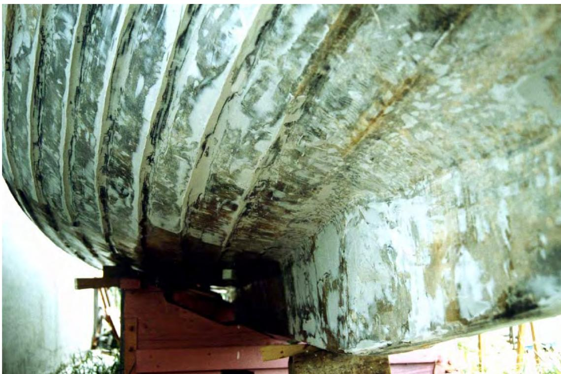
*Verniciatura bianca dell'opera morta e due mani di epossidica con additivo antiosmosi*
